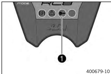
L'anti-démarrage électronique protège le véhicule contre tout usage intempestif. Il suffit de retirer la clé de contact pour activer automatiquement l'anti-démarrage et bloquer l'électronique moteur.
