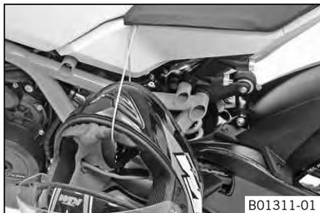
Les outils de bord incluent un câble d'acier permettant de cadenasser un casque sur le véhicule pour le protéger du vol.
