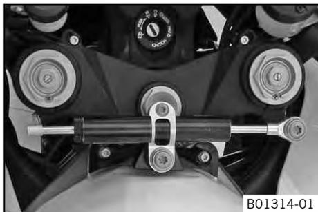
L'amortisseur de direction absorbe les coups de guidon survenant lors d'une accélération ou sur terrain accidenté, suite à un bref délestage de la roue avant ou en cas de rythme effréné.
