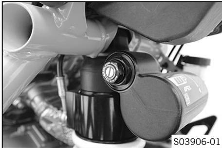
L'amortissement en compression de l'amortisseur est divisé en deux plages, la Grande Vitesse et la Petite Vitesse. La Grande et Petite Vitesse sont des paramètres qui se réfèrent à la vitesse de compression de l'amortisseur de la roue arrière, et non à la vitesse de la moto.
