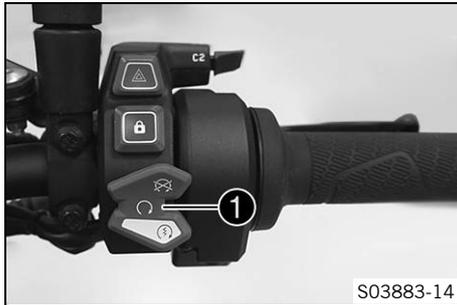
Le bouton d'arrêt d'urgence/bouton de démarrage **1** est situé à droite sur le commodo.
