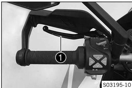
Le levier d'embrayage **1** est situé à gauche du guidon. L'embrayage à actionnement hydraulique s'ajuste automatiquement.
