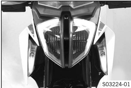
Les feux de virage se trouvent à droite et à gauche dans le déflecteur du réservoir de carburant.
