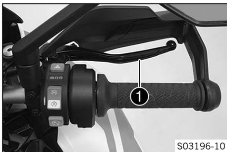
Le levier de frein à main **1** est situé à droite du guidon. Le levier de frein à main permet d'actionner le frein avant.
