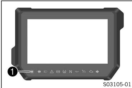
Le voyant de contrôle Race-on ① peut signaler des erreurs en se mettant à clignoter. Celles-ci sont indiquées pendant max. cinq secondes après actionnement du bouton Race-on.
