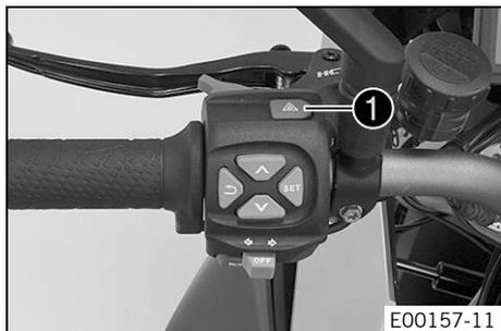
Le contacteur des feux de détresse ❶ se trouve sur le commodo de gauche. Les feux de détresse sont utilisés dans les cas d'urgence.
