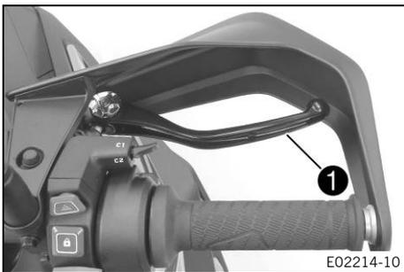
Le levier de frein avant ❶ se trouve sur le côté droit du guidon. Le levier de frein avant permet d'actionner simultanément les freins de roues avant et arrière.
