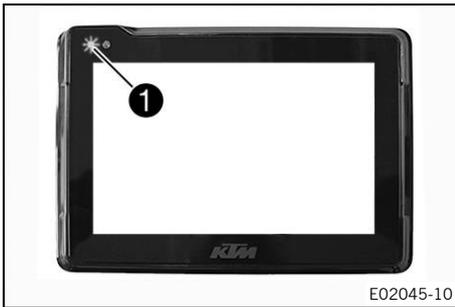
Le témoin de contrôle RACE ON **1** peut signaler des dysfonctionnements en se mettant à clignoter. Ceux-ci sont indiqués pendant cinq secondes maximum après actionnement de la touche RACE ON.
