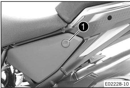
Le bouton **1** de déverrouillage de la selle passager est situé sur le côté gauche du véhicule, sous la selle passager. Le bouton de déverrouillage de la selle passager ne fonctionne que lorsque la moto est à l'arrêt, que le moteur est coupé et que le contact est mis ou a été coupé depuis moins d'une minute. Si le bouton de déverrouillage de la selle passager ne fonctionne pas, la selle passager peut être déverrouillée à l'aide du déverrouillage d'urgence de la selle passager (📖 p. 31).
