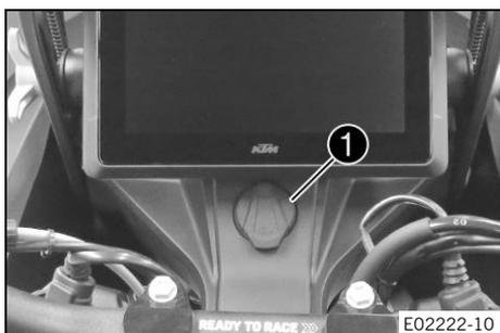
La prise ❶ pour accessoires électriques est située devant le té de fourche supérieur. Elle est branchée sur le plus permanent et protégée par un fusible.
