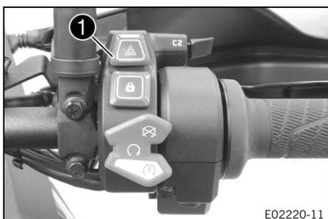
Le contacteur des feux de détresse ❶ est situé à droite sur le commodo.
