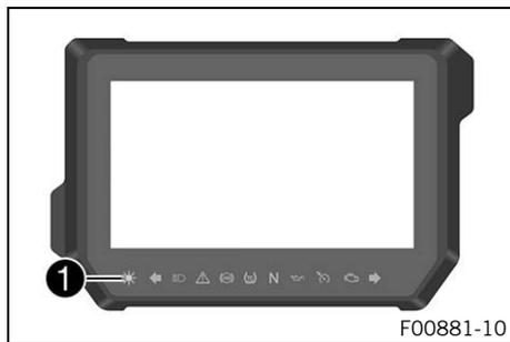
L'anti-démarrage électronique protège le véhicule contre tout usage intempestif. Dès lors que l'allumage est coupé au moyen du bouton Race-on (🔑 p. 34), l'anti-démarrage est activé et l'électronique moteur est bloquée.
