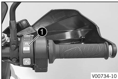
Le bouton d'arrêt d'urgence/bouton de démarrage ❶ est situé à droite sur le commodo.
