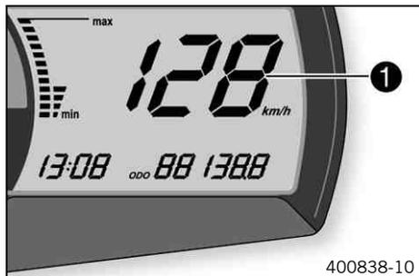
La vitesse ❶ est affichée en kilomètres par heure **km/h** ou en miles par heure **mph**.
