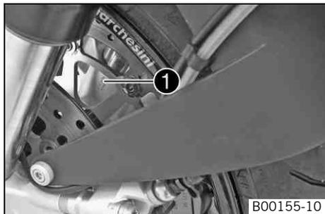
La référence de la fourche ❶ est frappée à l'intérieur de la fixation de l'axe de roue avant.
