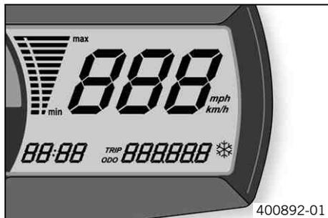
Lors de l'activation de l'allumage, tous les segments d'affichage s'allument une seconde pour un test de fonctionnement.
