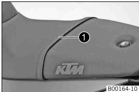
La courroie de fixation ❶ est montée sur la selle.
